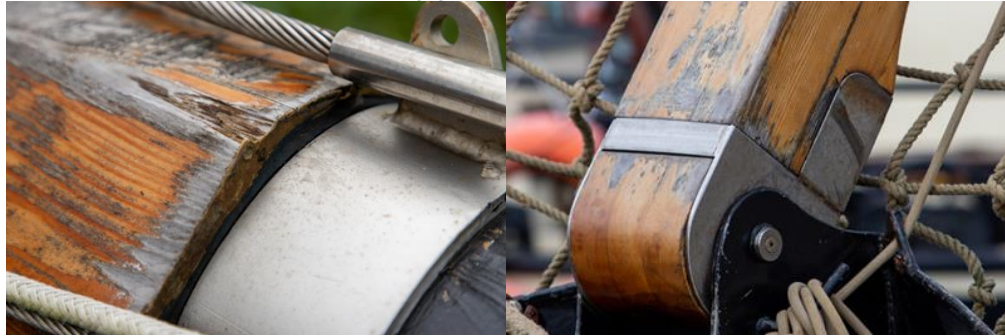
Figuur 5.14: Verkleuringen ter plaatse van de contactvlakken van staal op hout
