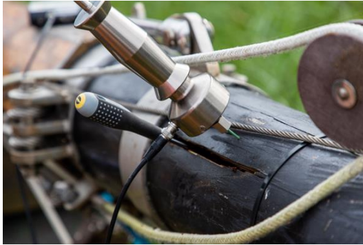
Figuur 5.3: Meten van houtvocht nabij een windscheur
