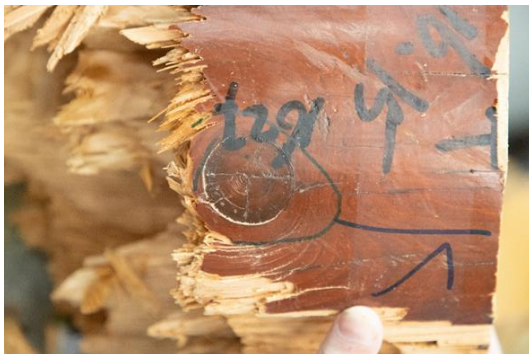
Figuur 5.7: Kwast die zich “aftekt”. Oppervlak van de kwast ligt een fractie hoger/lager dan het omringende hout
