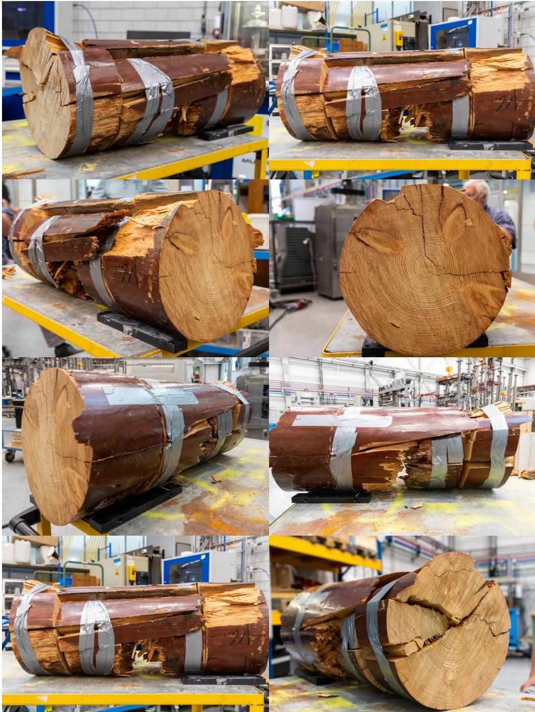
Figuur 4.13: Breuk mast in elkaar gelegd
