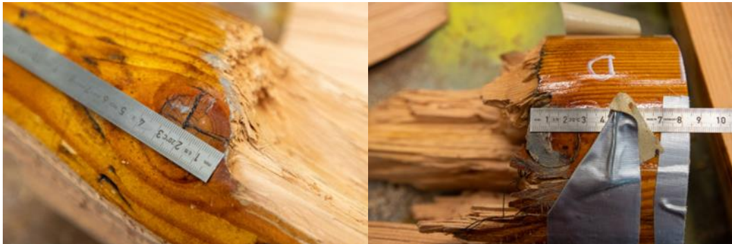
Figuur 3.12: Doorsneden van de kwasten in de bezaan giek
