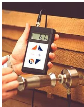
Figuur 5.2: Houtvochtmeter met slagmeetelektroden
