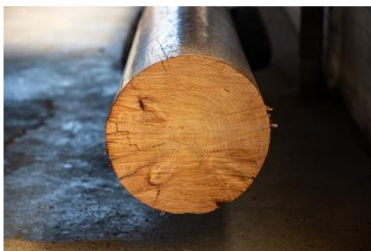
Figuur 4.6: Net onder de breuk op 15,8 meter
