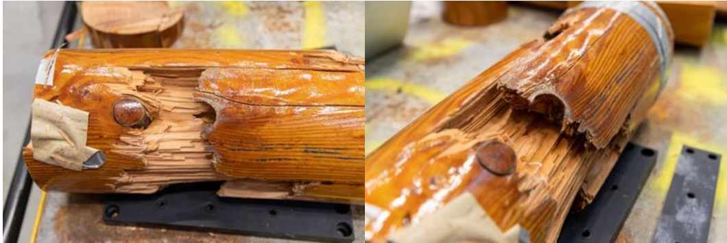
Figuur 3.9: Losse kwast aan de linkerzijde van de breuk (C)
