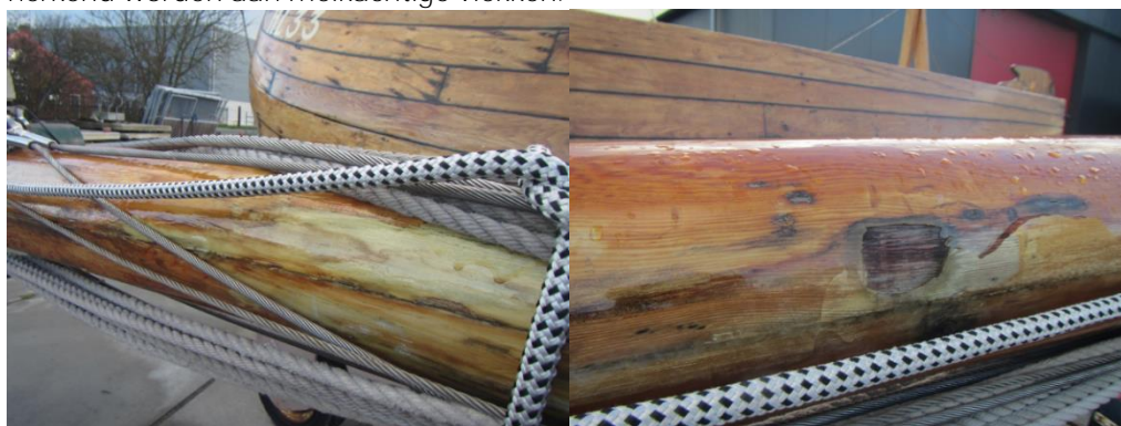
Figuur 5.17: Voorbeelden van vochtinwerking onder en/of onthechting van de coating
