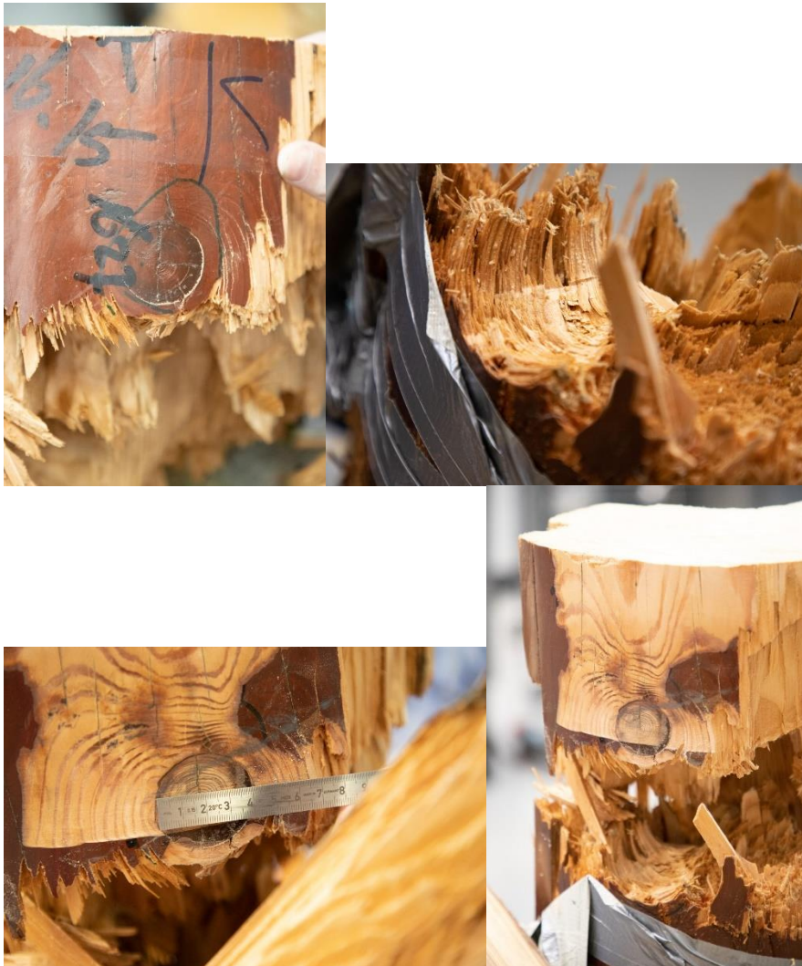
Figuur 4.15: Onvolkomenheden in de breuk – kwast
