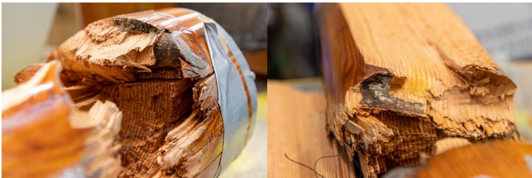
Figuur 3.8: Losse kwast aan de rechterzijde van de breuk (D)
