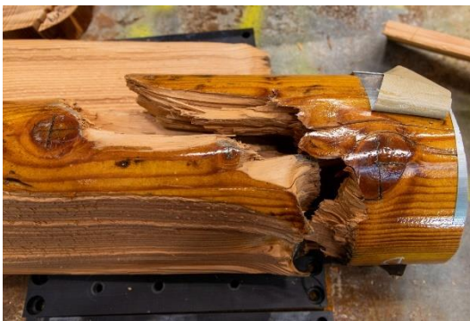
Figuur 3.7: Breuk in de waarschijnlijke onderzijde van de giek
