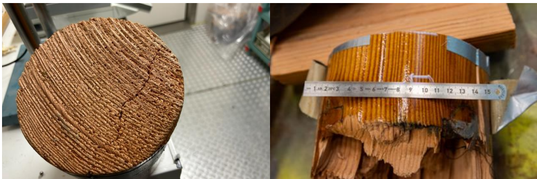
Figuur 3.3: De giek is buiten het hart van de boom gezaagd.
