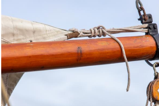
Figuur 5.5: Kwast in een giek.
