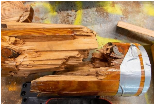
Figuur 3.6: Breuk in de waarschijnlijke bovenzijde van de giek
