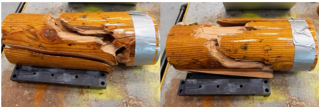
Figuur 3.10: Kwasten aan de onderzijde van de giek
