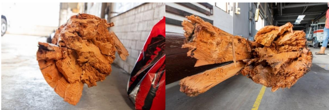
Figuur 4.2: De breuk van de beide mastdelen.
