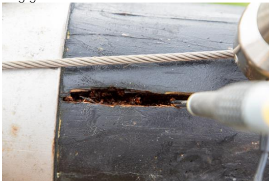
Figuur 5.4: Met een priem beoordelen of het hout al of niet zachter is dan het omringende hout
