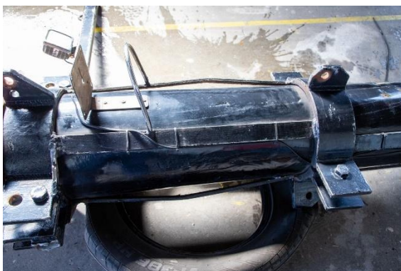
Figuur 4.12: Verbogen staalwerk bovenin de mast
