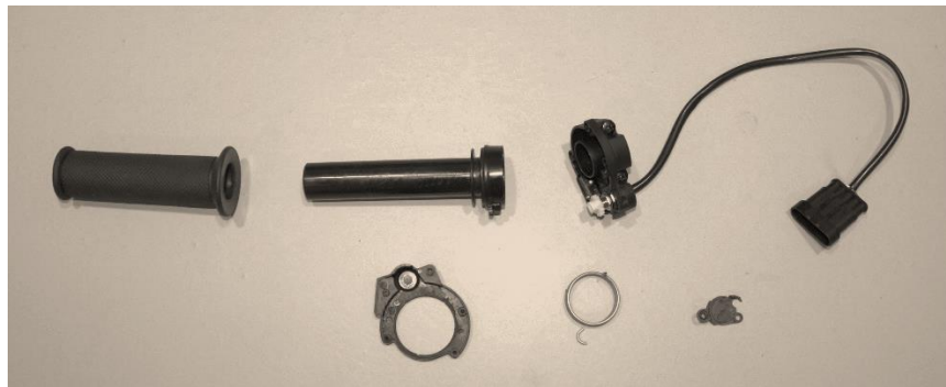
Figuur 16: Gedemonteerde gashendel
