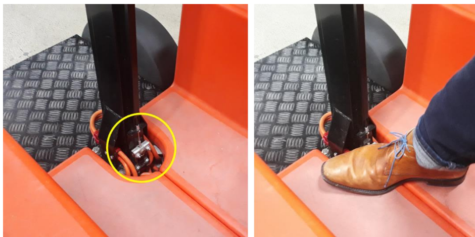
Figuur 11: Nieuw model Stint onbeschermd rembediening.
