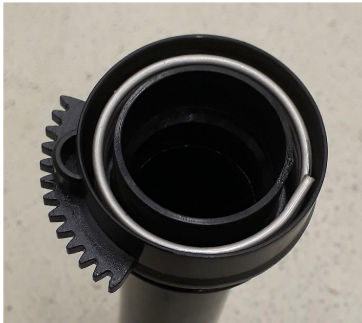
Figuur 17: Handvat met (gebroken) veer
