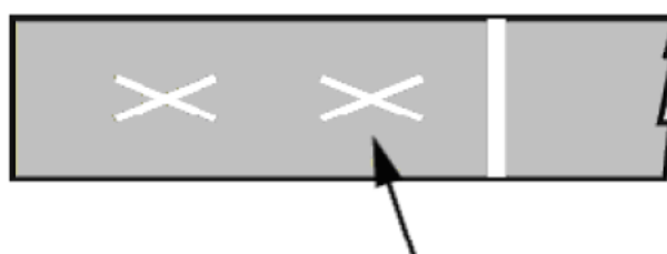
Figuur 6 - Markering baandrempel bij rijbaan voor baandrempel
