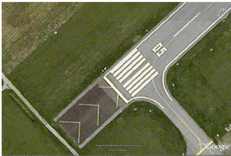
Figuur 4 - Markering gesloten gedeelte voor baandremmel door middel van chevrons
