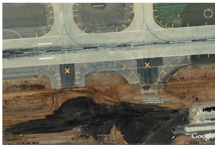
Figuur 10 - Praktijkvoorbeelden markering gesloten rijbaan
