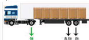
Gevolg na lossen lading: geen overbelading op de aslasten. Let daarbij op dat de lading goed gezekerd wordt.
