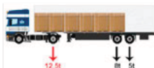
Gevolg na lossen lading: overbelading op aslasten
