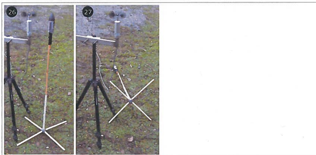
Foto 26. De lanceerstandaard met een 'grote' vuurpijl op onverharde ondergrond. Foto 27. Omgevallen lanceerstandaard.
