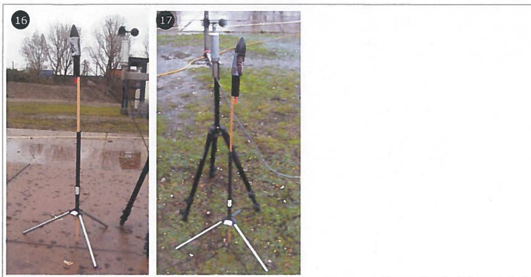
Foto 16. De lanceerstandaard met een 'grote' vuurpijl op verharde ondergrond. Foto 17. De lanceerstandaard met een 'grote' vuurpijl op onverharde ondergrond.
