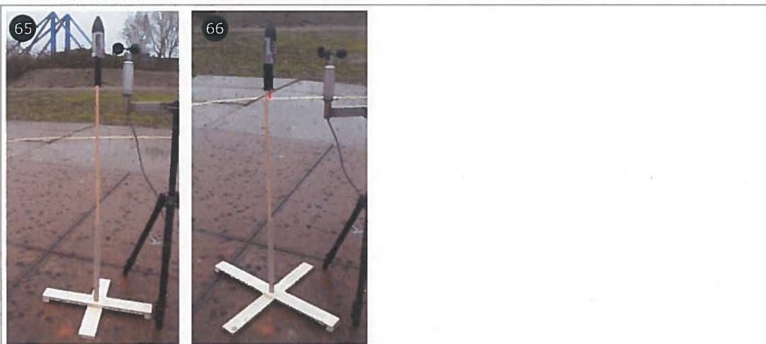
Foto 65. Uitvoering 2 van de lanceerstandaard met een 'grote' vuurpijl, verticale stand.
