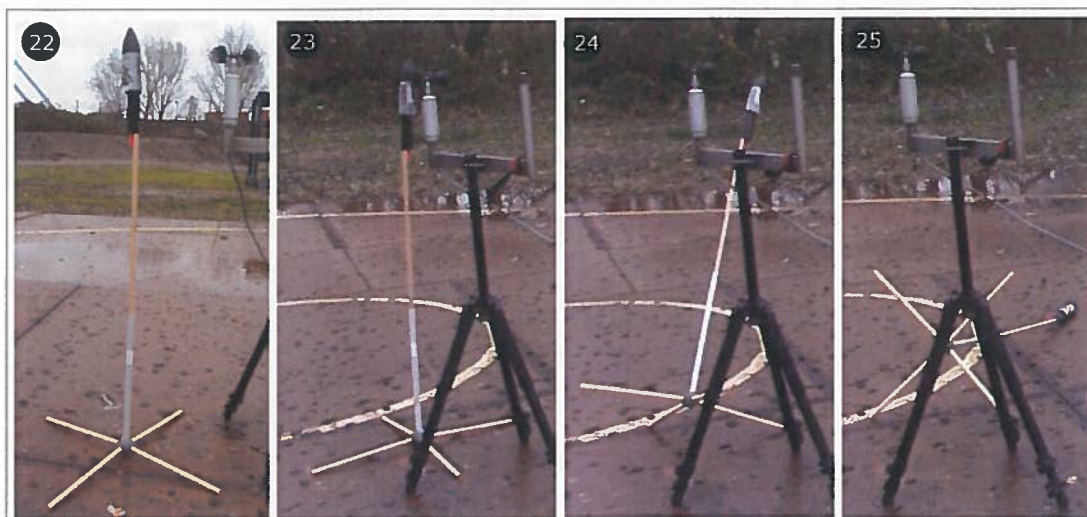
Foto 22. De lanceerstandaard met een 'grote' vuurpijl op verharde ondergrond – verticale stand. Foto 23 t/m 25. Omvallende standaard met een 'grote' vuurpijl op verharde ondergrond. [video-stills]
