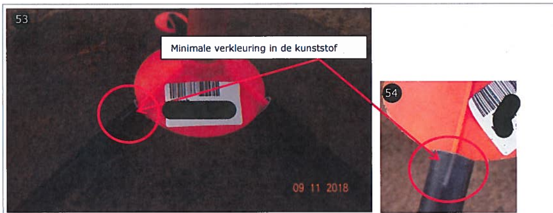
Foto's 53 en 54. Minimale verkleuring in de kunststof poten van de lanceerstandaard.
