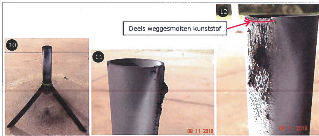
Foto's 10 t/m 12. Effect van de 'stress-test' op de lanceerstandaard.
