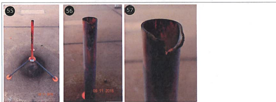
Foto's 55 t/m 57. Effect van de 'stress-test' op de lanceerstandaard.
