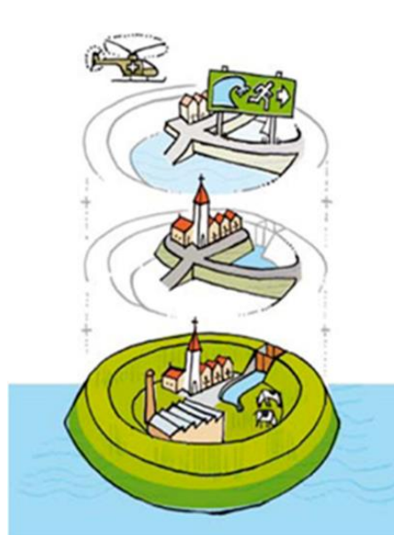
Figuur 1 - De 3 elementen van de Nederlandse veiligheid tegen overstromingen (meerlaagsveiligheid)
